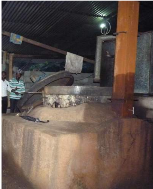
Alambic de distillation d'Ylang-Ylang (Source : Bahers, 2018)
